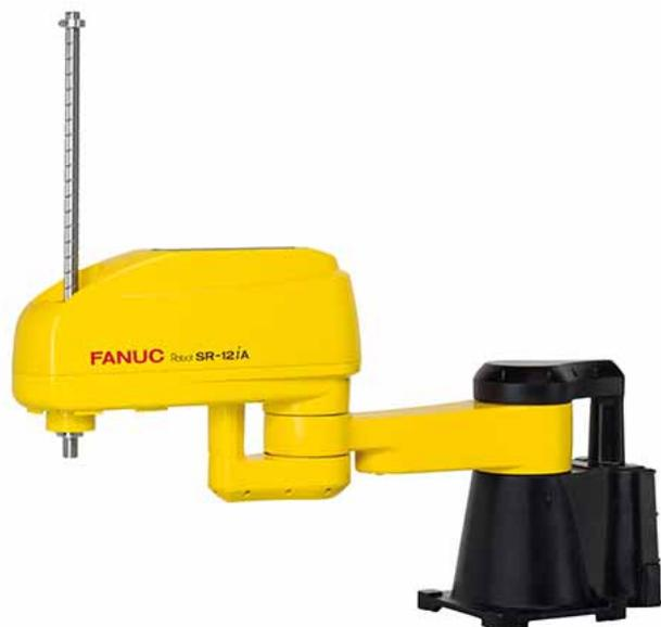
**FANUC ha presentado el tercer modelo de su línea de robots SCARA: el SR-12iA.** Este robot ofrece una capacidad de carga de 12 kg, su inercia de muñeca es de 0.30 kgm<sup>2</sup> y presenta una arquitectura pequeña lo que abre nuevas posibilidades en aplicaciones de ensamblaje y embalaje. Este modelo también estará disponible en versión Water proof.
