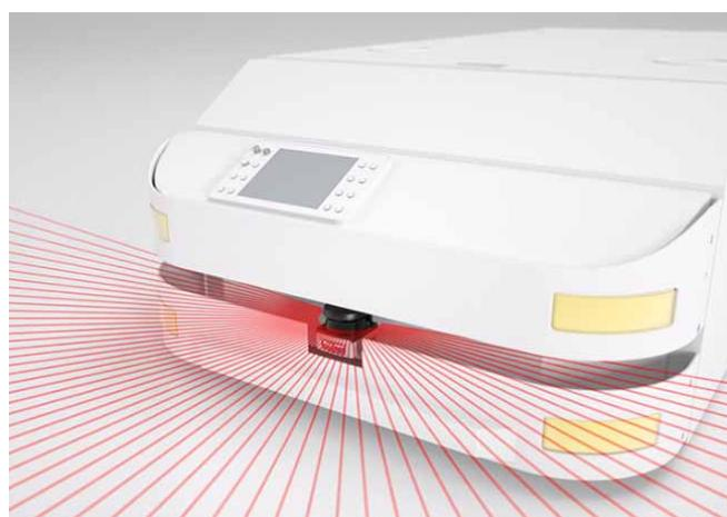
Gracias a la alta frecuencia de escaneo de 80 Hz, los escáneres láser de la serie ROD 100 son ideales para su uso en aplicaciones dinámicas, especialmente para evitar colisiones en sistemas de transporte sin conductor (AGVs) que circulan a gran velocidad.
