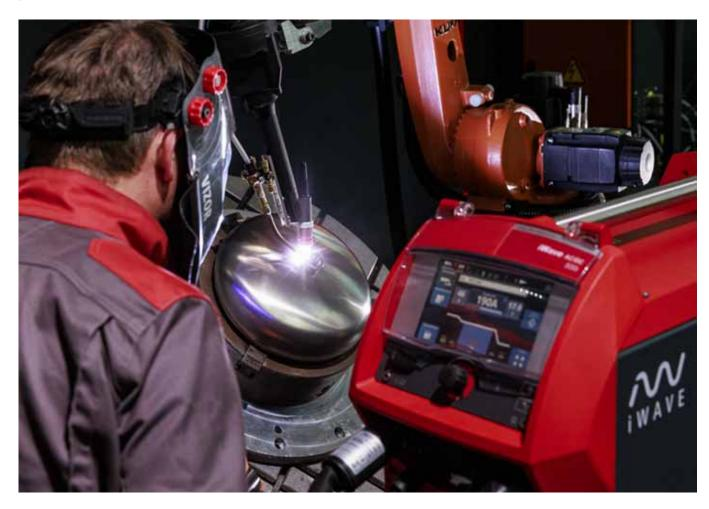
Este todoterreno de la soldadura está ahora disponible en los rangos de potencia 300i, 400i y 500i, cada uno de ellos como variante de DC o AC/DC y refrigerados por agua o gas, según requiera el usuario. Gracias a su control dinámico del hilo, establece nuevos estándares en la soldadura de hilo frío y, como versión Multiprocess Pro, ofrece una solución 2 en 1 preparada para el futuro en la soldadura TIG y MIG/MAG de alta gama.
