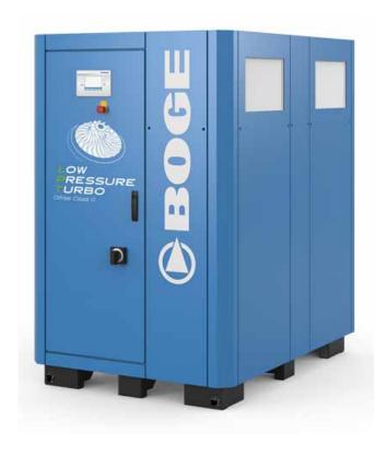
Gracias a un innovador diseño que se basa en rodamientos neumáticos para el eje de transmisión, no se necesita ni aceite ni grasa para producir aire comprimido de clase 0 (libre de aceite). Y gracias al alto rendimiento del motor de imanes permanentes, el LPT 150 alcanza presiones de entre 2,0 y 4,0 bar con un coste mínimo, ¡ocupando menos de la mitad de la superficie que un compresor de tornillo sin aceite!
