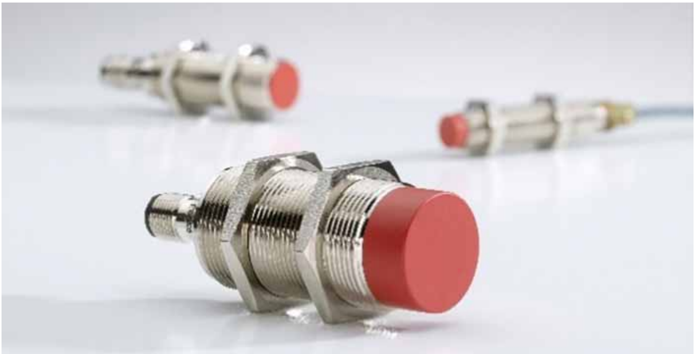
Leuze presenta sus nuevos sensores inductivos: los dispositivos de la serie IS 200MM.2 permiten unas distancias de conmutación de hasta 40 milímetros y detectan de manera fiable objetos metálicos, incluso a grandes distancias.
