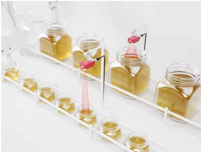
Los sensores de ultrasonidos de la serie 420B tienen un cono acústico ajustable. Se puede seleccionar un cono estrecho, medio o amplio dependiendo de la aplicación. Esto permite, por ejemplo, supervisar niveles de llenado a través de aberturas en recipientes de diferentes tamaños.
