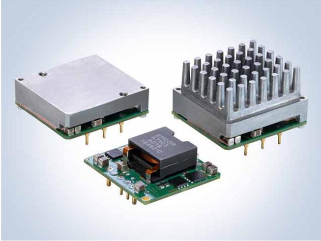
TDK Corporation (TSE 6762) anuncia la incorporación de modelos con límite de corriente ajustable a la serie TDK-Lambda i7C de convertidores CC-CC no aislados de 300 W. Estos módulos de alimentación buck-boost, y de montaje en tarjeta, tienen rangos de entrada de 9 a 53 Vdc con ajuste de tensión de salida de 5 a 28, de 8 a 24 o de 9,6 a 48 V, en función de la ratio de corriente de salida.
