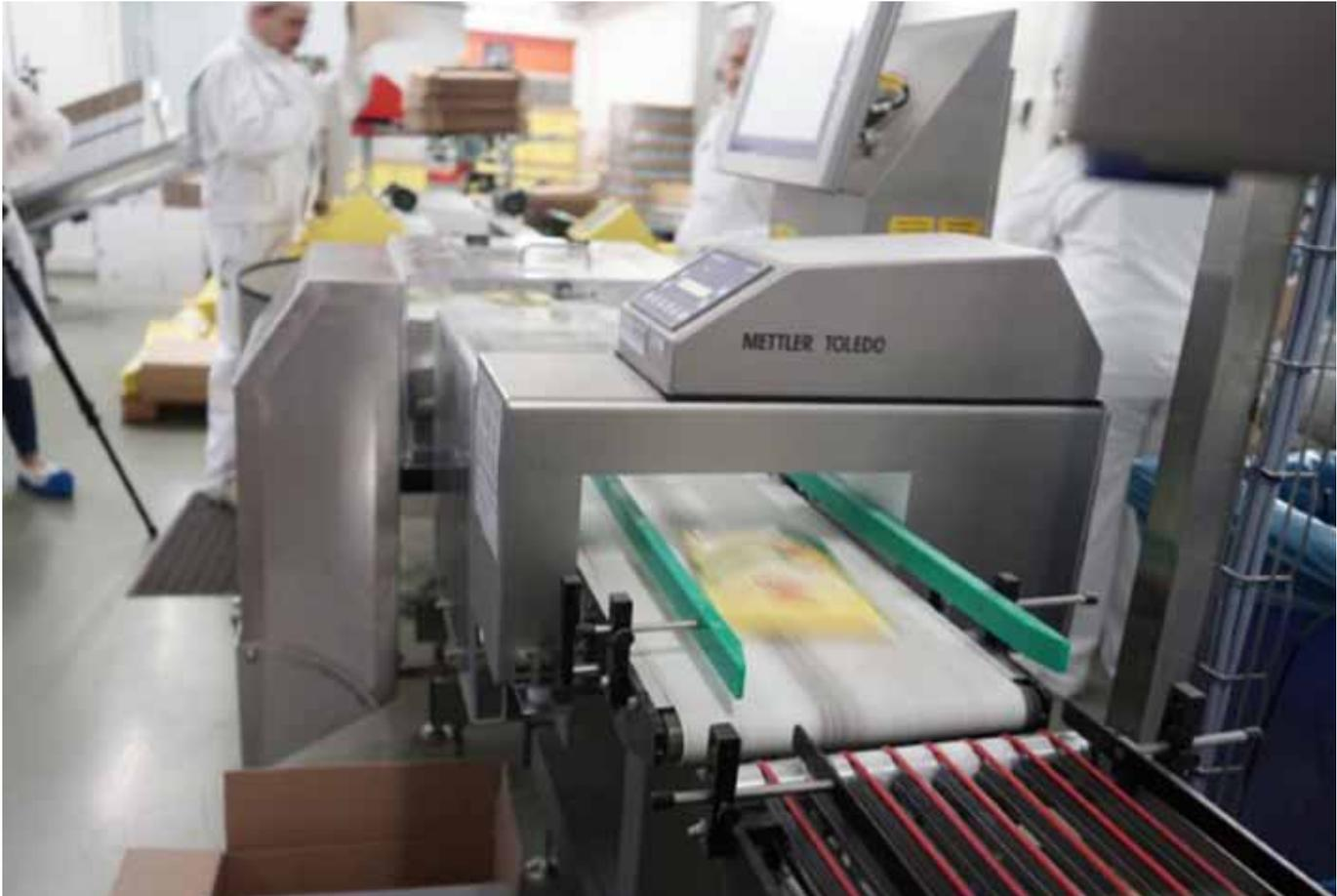
rápida, lo que lo hace ideal para las fábricas que necesitan cambios frecuentes de tarea con estrictos regímenes de lavado. El diseño de la estructura de la máquina se basa en superficies inclinadas que ayudan a minimizar el riesgo de que los ingredientes o los contaminantes se acumulen en las esquinas, lo que facilita y agiliza la limpieza. El diseño de CM Washdown Combination también incluye un desmontaje y un montaje sencillos de las piezas.
