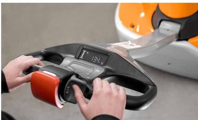
visibilidad inmediata a la información más relevante: una pantalla LED y una pantalla táctil. La pantalla LED muestra detalles importantes como el estado de la carga, las horas de funcionamiento y las indicaciones para el operario.
