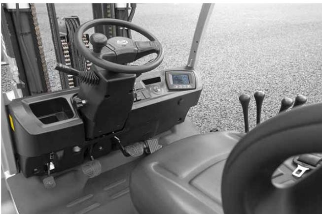
que ofrecen la potencia perfecta para responder tanto en interiores como en exteriores. Además, su transmisión hidrodinámica con convertidor de par ofrece un manejo suave y preciso que facilita las maniobras y los cambios de dirección ágiles.
