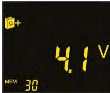
Paso 2: tensión de contacto
