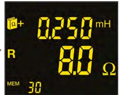
Paso 3: valor de la parte resistiva e inductiva de la impedancia medida
