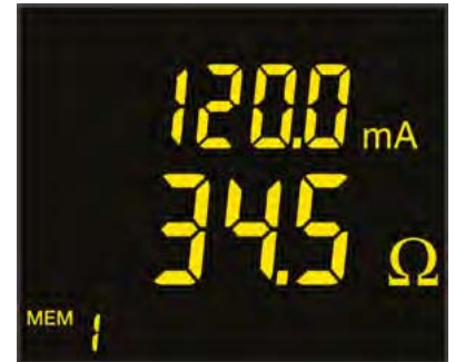
Modo estándar: Impedancia y corriente de fuga
