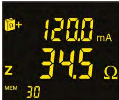
Paso 1: impedancia y corriente de fuga
