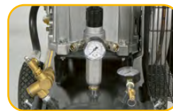
Regulador de presión de gran tamaño con doble salida de aire comprimido
