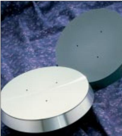
Cuando Watlow fabrica un calefactor integrado según las especificaciones de un cliente, el resultado no es "cualquier" calefactor. Se trata siempre de un calefactor especial que forma parte de su aplicación. En el calefactor IFC (procedimiento de montaje a presión) se monta un calefactor tubular de Watlow bajo presión en una ranura practicada sobre una placa metálica diseñada específicamente para su aplicación.
