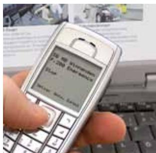
Todo de un vistazo: en caso de avería, pueden pedirse datos directamente por SMS o correo electrónico a través del Remote Diagnostic System (RDS I).
