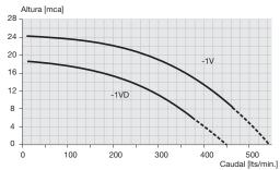
Datos con agua a 20°C, 50Hz, 2800rpm Densidad máximo del fluido bombeado:
