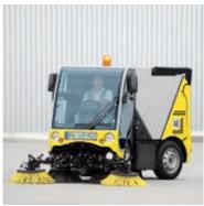
Con sistema de circulación del agua para unos largos intervalos de trabajo activo. El agua sucia recogida en el depósito para la suciedad se utiliza repetidas veces para evitar la formación de polvo en la boca de aspiración. Incluido en el equipo de serie de los modelos ICC 2: en la presentación Adv o Comfort.
