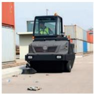
Cabinas y techos de protección para una mayor seguridad, por ejemplo, en almacenes con estanterías. A elegir con calefacción o aire acondicionado. Iluminación y lámpara de advertencia omnidireccional para una mayor seguridad y mejor visibilidad y para trabajar en deficientes condiciones meteorológicas, por ejemplo, en invierno.
