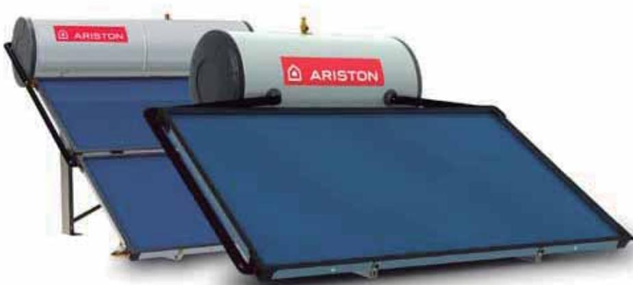
En las instalaciones de energía solar térmica, el calor se transfiere por medio de un fluido (una mezcla de agua y glicol) llamado "termovector", que circula entre el colector solar y el interacumulador. En instalaciones de circulación natural, el fluido circula de forma espontánea, transfiriendo el calor de los colectores solares al acumulador.
