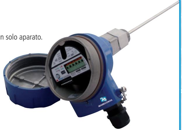
Los impulsos por microondas generados por la electrónica y de alta frecuencia son guiados a lo largo de una sonda conductiva, que está sumergida dentro del producto. Si los impulsos llegan a la superficie del líquido o polvo, partes de la energía de los impulsos son reflejados a través de la sonda. La electrónica calcula el nivel del producto por medio de la diferencia del tiempo entre los impulsos enviados y reflejados.
