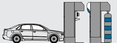
1. Posicionamiento del vehículo delante del portal del lavado. El portal de lavado se encuentra detrás en posición inicial.
