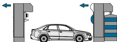
2. El portal de lavado avanza en recorrido en vacío hacia la posición de espera a la entrada de la instalación. Según el equipamiento, durante ese recorrido se realiza el lavado con alta presión o la espuma.
